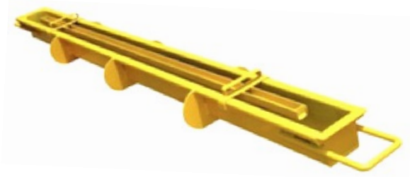
Moldes para cierres perimetrales: poste , placa, barda
